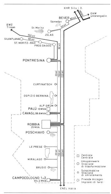
Fig. 2 Hochspannungsnetz der KWB
