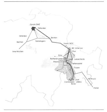
Fig. 5 Regeltechnisch an 220-kV-parallelgeschaltete Versorgungsgebiete
