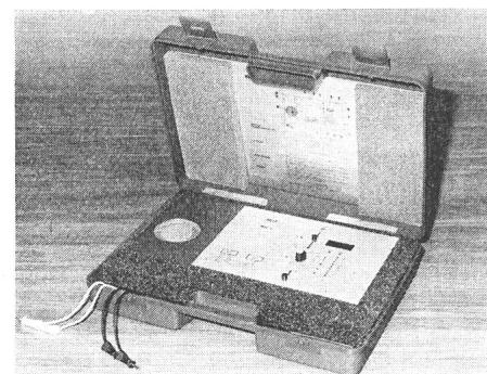
impedanzen (Betrag und Winkel), Kurzschlussleistungen sowie Spannungen und Meßstrom. Aufgrund dieser Werte kann die Fehlerspannung ermittelt werden. Die Messgenauigkeit, abhängig von Netzstabilität und Netzimpedanz, liegt allgemein bei 5 %. (Société industrielle de la Doux, 2035 Corcelles)
