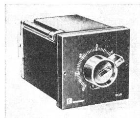
Umschaltkontakt; Funktionsanzeige durch Ablaufzeiger. Die Befestigung des Aufbaumodells erfolgt durch 2 M5-Schrauben oder mittels Schnellbefestigung auf DIN-Tragschienen 46277/3. Beim Einbaumodell erfolgt die Montage durch einfache Schalttafelbefestigung oder mittels speziellen Montagesockeln.
