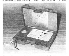
impedanzen (Betrag und Winkel), Kurzschlussleistungen sowie Spannungen und Meßstrom. Aufgrund dieser Werte kann die Fehlerspannung ermittelt werden. Die Messgenauigkeit, abhängig von Netzstabilität und Netzimpedanz, liegt allgemein bei 5 % (Société industrielle de la Doux, 2035 Corcelles)
