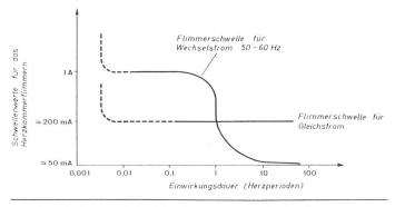
Fig. 6 Prinzipieller Verlauf der Schwellenwerte für das Auslösen von Herzkammerflimmern bei Wechselstrom 50...60 Hz und Gleichstrom, bei Längsdurchströmung
