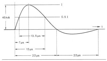
Fig. 8 Stromverlauf des experimentellen Blitzes
