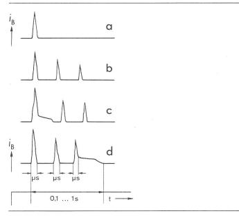
Fig. 4 Prinzipielle Darstellung des Stromverlaufes i<sub>B</sub> von Abwärtsblitzen
