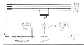
Fig. 11 Messung der Berührungsspannung der Aufstallung gegen die Standfläche der Hinterbeine der Rinder Messelektrode 250 × 250 × 2 mm
