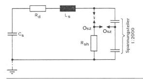
Fig. 7 Schaltbild des Blitzstoßspannungsgenerators  $C_{\rm s}=1.2~\mu{\rm F},~R_{\rm d}=5~\Omega,~L_{\rm s}=30~\mu{\rm H},~R_{\rm sh}=16~{\rm m}\Omega,$  Osz Oszillograph
