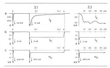
Fig. 5 Beispiel eines negativen Abwärtsblitzes mit zwei Teilblitzen
