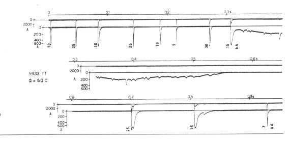
Fig. 3 Strom-Oszillogramm eines negativen Abwärtsblitzes vom Typ 1b mit 11 Teilblitzen Gleiches Oszillogramm in zwei Strommaßstäben
