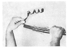
mit abziehbarer äusserer Leitschicht, die in einem Arbeitsgang mit der Leiterglättschicht und der Isolation aufgespritzt wird, eine Weiterentwicklung von Câbles Cortaillod S.A., 2016 Cortaillod, bringt entscheidende Verbesserungen mit sich:
