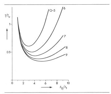
Fig. 4 Relative Rauschtemperatur als Funktion des Hilfs-/Signalfrequenz-Verhältnisses  $f_1/f_2$ . Parameter ist die Diodengüte  $T_{\rm u}$  Physikalische Temperatur des Verstärkers
