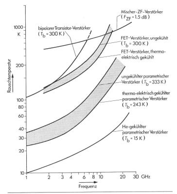
Fig. 1 Rauscheigenschaften verschiedener Mikrowellenverstärker mit Halbleitern
