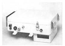
Fig. 6 Parametrischer Verstärker für 11 GHz
