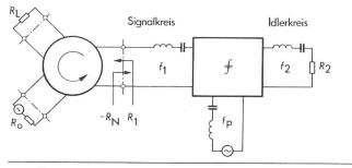
Fig. 3] Ersatzschaltbild des parametrischen Reflexionsverstärkers
