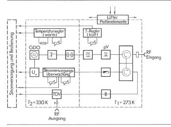
Fig. 5 Blockschaltbild eines parametrischen Verstärkers mit Tunneldioden-Nachverstärker für 11 GHz
