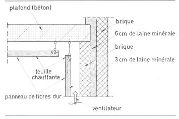
Fig. 2 Panneaux radiants avec circulation d'air forcée
