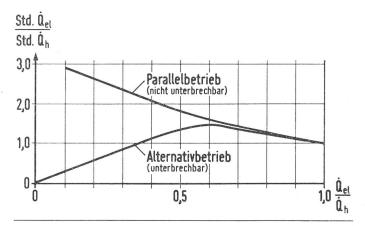
Fig. 6 Bivalente Heizung: Benutzungsstunden der elektrischen Raumheizung
