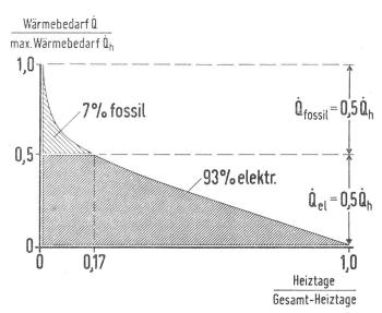
Fig. 1 Bivalente Wärmebedarfsdeckung im Parallelbetrieb (Jahresdauerlinie für Raum Essen)
