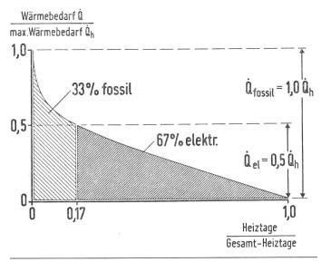
Fig. 2 Bivalente Wärmebedarfsdeckung im Alternativbetrieb (Jahresdauerlinie für Raum Essen)
