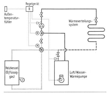
Fig. 10 Schema einer bivalenten Wärmepumpenheizungsanlage. Wärmepumpe in Betrieb
