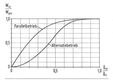
Fig. 5 Bivalente Heizung: Anteil der Elektroheizung an der Deckung j des Jahreswärmebedarfes (Raum Essen)
