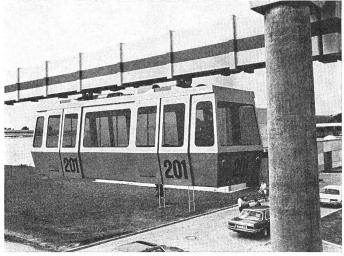
1978 vollautomatisches Fahren mit sechs Kabinen, und zwar mit zwei Kabinentypen, einer Kleinkabine für 17 und einer mittelgrossen für 40 bis 50 Insassen. In Spitzenverkehrszeiten können zwei gekoppelte Fahrzeuge dieser Art im 60- bis 80-Sekunden-Takt auf einer Linie in jeder Richtung stündlich 5000 bis 6000 Personen befördern. Für besondere Fälle, mehr als 10 000 Fahrgäste je Stunde, sind Gelenkkabinen mit über 200 Plätzen vorgesehen.
