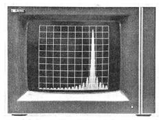
entwickelten Verstärkerschaltungen erhöhen die Zuverlässigkeit. Im Gegensatz zu Sichtgeräten mit magnetischer Ablenkung verfügt dieses Modell dank der elektrostatischen Ablenkung über hohe
