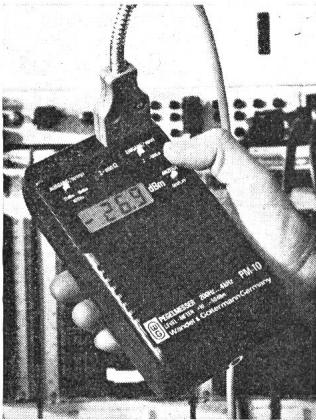
10 darüber hinaus noch klein, leicht, handlich und netzunabhängig ist, sich problemlos bedienen lässt und eine einfache Messergebnisablesung gewährleistet, erfüllt er alle Anforderungen eines Betriebsmessgerätes.
