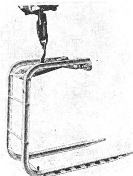
derkraft in Zwangsstellung gehalten, eine stets horizontale Lage der unbelasteten Krangabel ergibt. Dadurch kann auch eine grosse und schwere Krangabel mühelos in Stellung gebracht und wieder vom Palett weggezogen werden. Die Krangabel mit Selbstausgleich von L. Meili & Co. AG, 8046 Zürich, ist in vier Typen für 800 bis 8000 kg Tragkraft und 1050 bis 2100 mm Nutzhöhe erhältlich.
