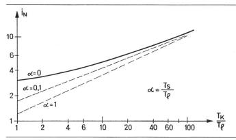
Fig. 10 Scheitelwerte der normierten Ströme i(x=0,t) in Fig. 5 bei verschiedenen  $T_{\rm k}/T_{\rm l}$ -Werten und bei unterschiedlich schnellen Spannungszusammenbruchszeiten  $T_{\rm s}$  am Schalter
