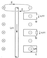
Fig. 2 Zur Induktion durch das Magnetfeld eines stromführenden Leiters
