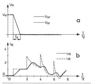
Fig. 9 Spannung  $u_s(t)$  am Schalter und Strom i(x=0, t) gegen Erde in Fig. 5
