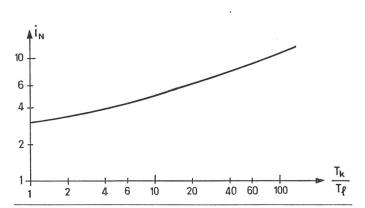
Fig. 8 Scheitelwerte der normierten Ströme  $i_{\rm IN}$  (x=0,t) in Fig. 5 bei verschiedenen  $T_{\rm k}/T_{\rm l}$ -Werten
