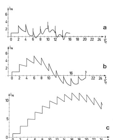
Fig. 7 Der zeitliche Verlauf des normierten Gesamtstromes i<sub>1N</sub> (x = 0, t) in der Schaltung nach Fig. 5 bei rechteckförmigem Spannungszusammenbruch am Schalter
