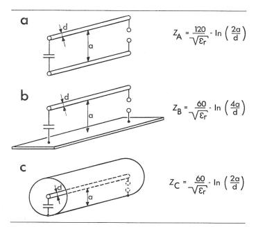
Fig. 12 Wellenwiderstände von Anordnungen mit unterschiedlichem Abschirmungsaufwand
