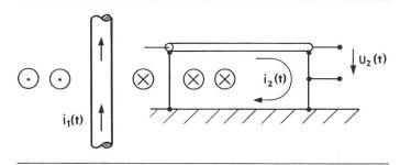
Fig. 4 Induktion eines Stromes  $i_2(t)$  im Mantel eines Koaxialkabels durch das Magnetfeld eines Stromes  $i_1(t)$
