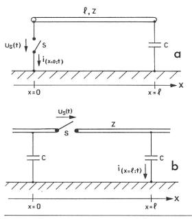
Fig. 5 Grundanordnung zur Berechnung des Stromes bei Überschlägen in Prüfkreisen
