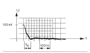
Fig. 1 Spannungszusammenbruch beim Durchschlag einer Kugelfunkenstrecke (ohne Überspannung) in Luft bei 1 bar
