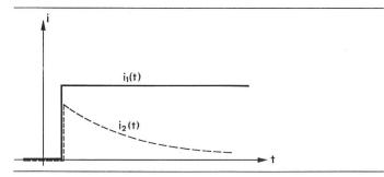
Fig. 3 Form des Stromes  $i_2(t)$  in Fig. 2c bei rechteckförmiger Erregung  $i_1(t)$
