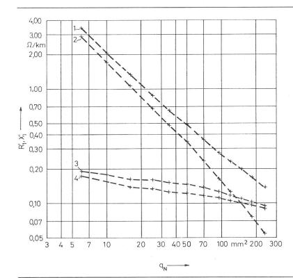
Fig. 3 Mitresistanz- und Mitreaktanzbelag von Einleiterkabeln in Abhängigkeit vom Leiterquerschnitt q<sub>N</sub> 1 R'1 max 2 R<sub>1min</sub> 3 X<sub>1max</sub>
