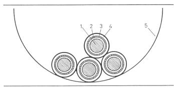
Fig. 1 Anordnung eines Einleiterkabelsystems (4×95 mm² Cu) im Schutzrohr (Innendurchmesser 150 mm)
