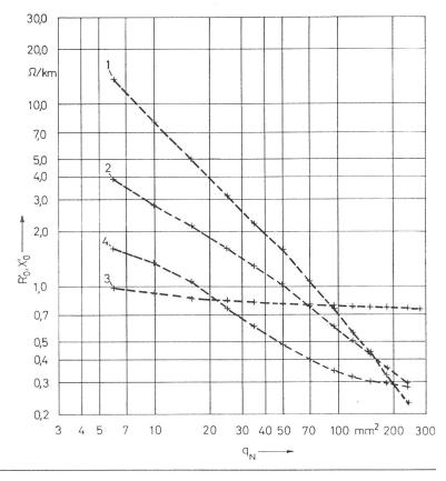
Fig. 4 Nullresistanz- und Nullreaktanzbelag von Einleiterkabeln in Abhängigkeit vom Leiterquerschnitt q<sub>N</sub>  $2 R'_{0min}$   $3 X'_{0max}$ 1 R'omax
