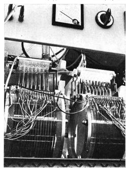
Druckgasflaschen betrieben. Sie verbrauchte im letzten Jahr bei nur halbjährlichem Flaschenwechsel 9,6 kg H2 und 100,1 kg O2 sowie als Elektrolyt 26,2 kg Kaliumhydroxid; einziger «Abfall» ist dabei Wasser.
