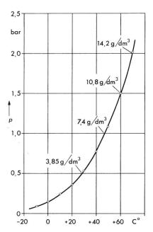
Fig. 1 Dampfdruckkurve von Frigen 113 mit Angabe der Gasdichte an einigen charakteristischen Punkten [2]
