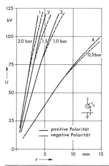
Fig. 2 Positive und negative Durchschlaggleichspannung von Frigen 113 bei der Anordnung  $A_1$  ( $r_0 = 25$  mm) in Abhängigkeit der Schlagweite s
