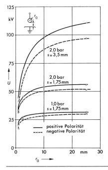
Fig. 4 Positive und negative Durchschlaggleichspannung in Abhängigkeit des Krümmungsradius r<sub>0</sub>
