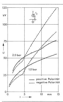
Fig. 6 Positive und negative Durchschlaggleichspannung der Anordnung  $A_4$  ( $r_0 = 1,0$  mm) in Abhängigkeit der Schlagweite s
