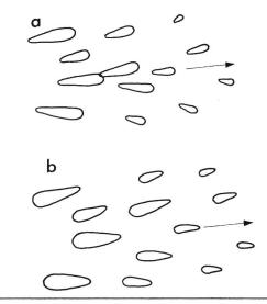
Fig. 3 Streamer négatif (a) et positif (b), avalanches élémentaires, flèches indiquant la direction de propagation du streamer
