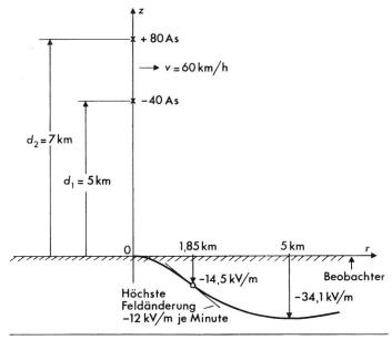
Fig. 7 Bodenfeldstärke  $E_{1,2}$  eines hochliegenden Wolkendipols mit  $Q_1/Q_2=$  —2 und  $d_1/d_2=$  0,71
