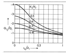
Fig. 4 Ladungsverhältnis  $Q_2/Q_1$  mit Parameter  $d_1/d_2$ , für die die Bodenfeldstärke  $E_{1,2} = \mathbf{0}$  wird
