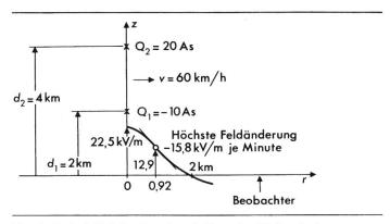
Fig. 6 Bodenfeldstärke  $E_{1,2}$  eines tiefliegenden Wolkendipols mit  $Q_2/Q_1 = -2$  und  $d_1/d_2 = 0.5$
