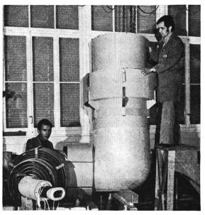
Fig. 6 Einbaufertige Hochspannungsausleitung aus Transformerboard, Reihe 400 kV
