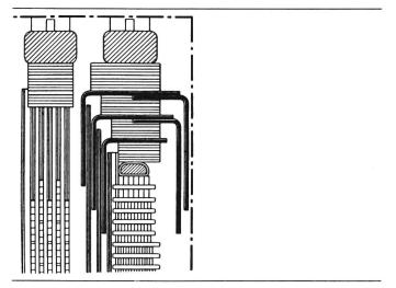
Fig. 1 Barrieren-Isolation mit Zylindern und Winkelringen aus Hartpapier
