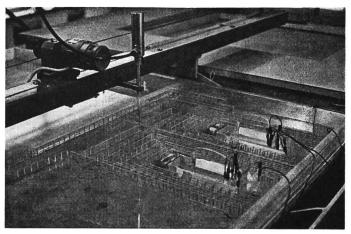
Fig. 7 Feldbild für die Dimensionierung einer Gleichspannungsisolation +/-- 500 kV (USA)
