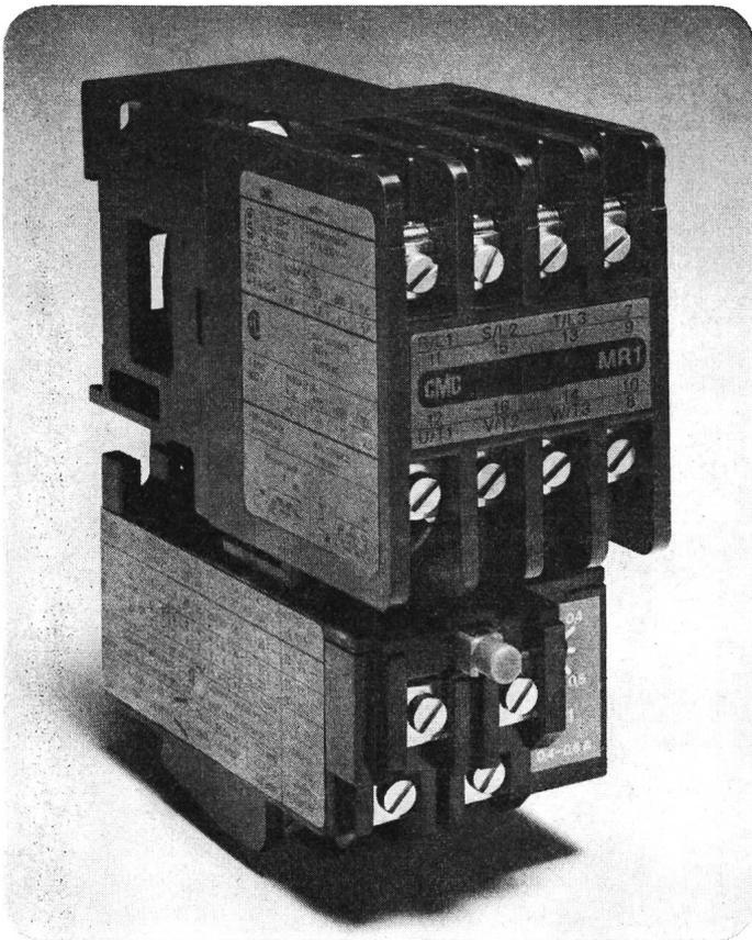
Für Motornennströme bis 9 A wurde ein neues, kompaktes und robustes Klein-Motorschütz entwickelt. Seine Hilfskontakte können durch den Anwender zur Schliesser- oder Öffnungsfunktion gewechselt werden. Die Klemmen sind klar und übersichtlich angeordnet, sie haben anschlussfreundliche Abhebebriden. Bei der bewährten CMC-Schütze-Reihe mit wechselbaren Hilfskontakten wurden drei Leistungsdaten verbessert:
