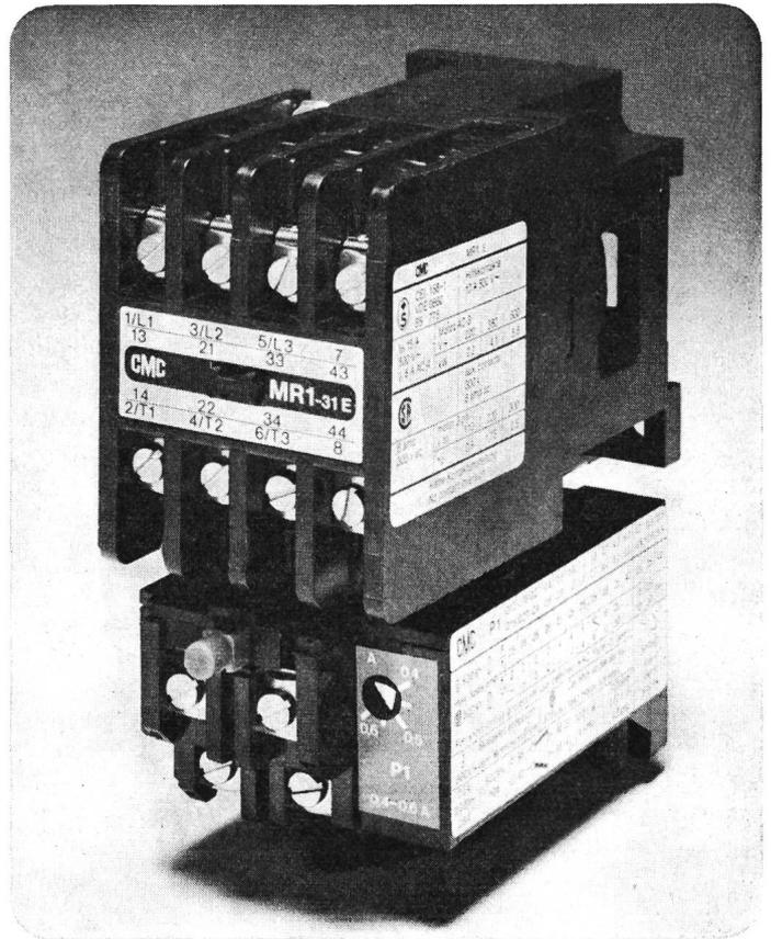
Für Motornennströme bis 9 A wurde ein neues, kompaktes und robustes Klein-Motorschütz entwickelt. Mit fester Hilfskontakt-Bestückung, definierten Klemmenbezeichnungen und genormten Befestigungsmassen für die exportorientierte Industrie.
