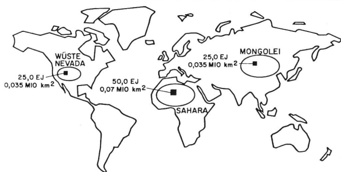
Fig. 18 Flächenbedarf für die Bereitstellung von jährlich 100 EJ mit Sonnenenergie
