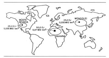
Fig. 18 Flächenbedarf für die Bereitstellung von jährlich 100 EJ mit Sonnenenergie
