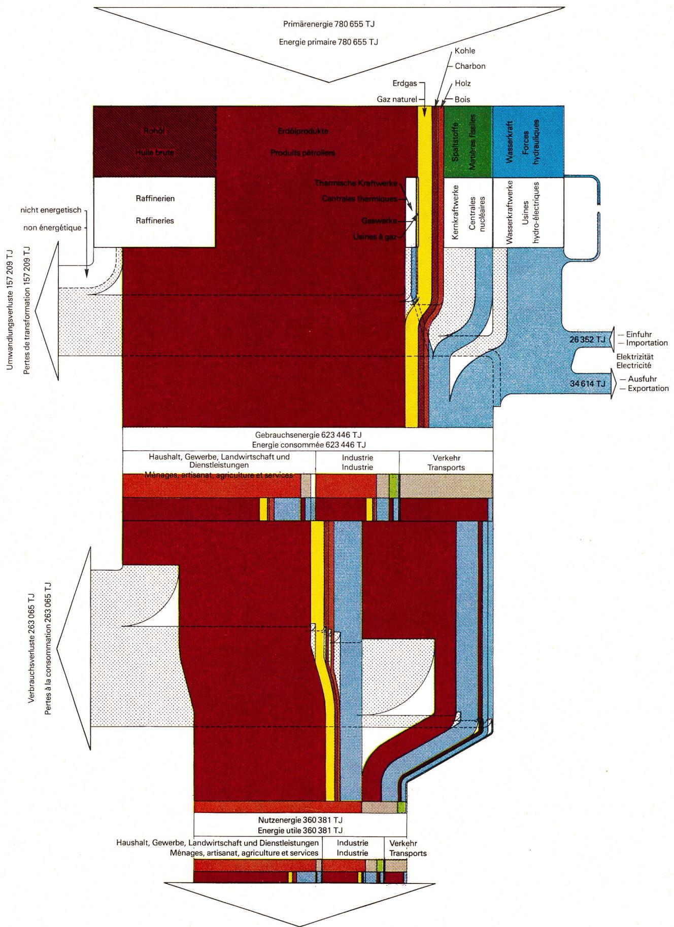
Fig. 1 Energiefluss der Schweiz 1976 (aufgrund der Statistiken des EAEW und des SNC)
