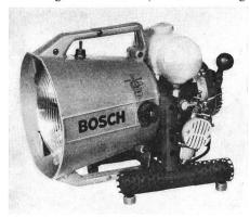
Der Lichtaustritt des Scheinwerfers hat einen Durchmesser von 175 mm; er erreicht eine Beleuchtungsstärke von 500 Lux in 10 m und noch 100 Lux in 23 m Entfernung. Der Strom wird in einem sechspoligen, von Dauermagneten erregten und an den Motor angeflanschten Generator von 150 W Leistung erzeugt. Das leicht transportable Flutlicht-Kleinkraftwerk dürfte vor allem für Polizei, Feuerwehren und Rettungsdienste, aber auch für Industriebetriebe und Werke von Nutzen sein. (Robert Bosch AG, 8021 Zürich)
