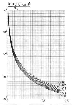
Courbes permettant de déterminer les constantes  $k_1$ ,  $k_p$  et  $k_d$ Fig. 7 du régulateur PID
