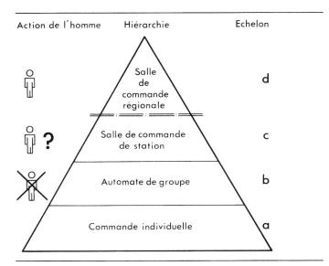
Fig. 1 Pyramide d'organisation dans la conduite des réseaux Tâches des échelons:
