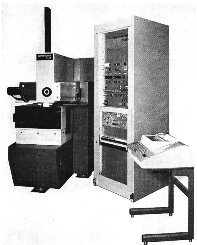
Fig. 4 Machine pour la mise en œuvre du principe du découpage par fil
