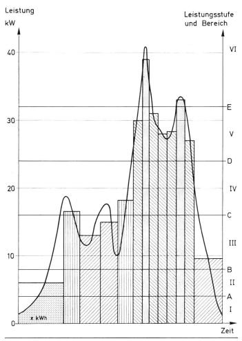
Fig. 4 Anzeigebeispiel eines Energie-Leistungsanalysators gemäss Fig. 5
