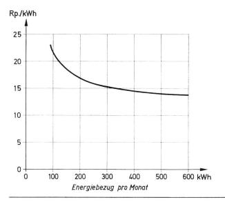
Fig. 7 Degressivität eines Haushalt-Einheitstarifes
