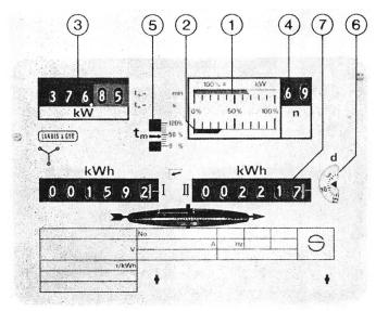
Fig. 1 Zifferblatt eines Maximumzählers
