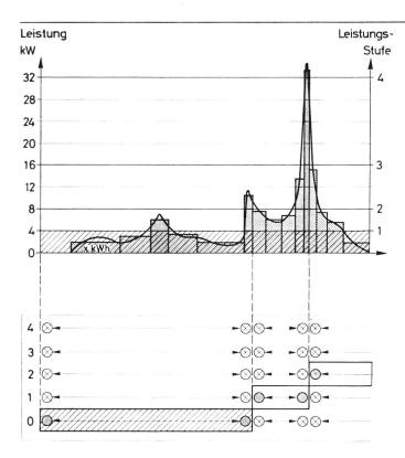
Auf die verschiedenen Ausführungsmöglichkeiten des Maximumzählers sei hier nicht näher eingegangen. Die grobe Übersicht macht jedoch deutlich, dass mit diesem Apparat eine flexible Handhabung des Tarifes ermöglicht wird.
