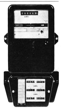
sung erhalten bleiben. Auch bei diesem Gerät lassen sich die verschiedenen Leistungsbereiche durch programmierte Schwellwerte vorwählen. Die Summe der auf den Zählwerken angegebenen Energiewerte stimmt mit der Angabe des Energiezählers überein, sofern Beginn und Ende der Gesamtmessung notiert und verglichen werden.
