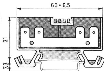
sentliche Vorteile. Werden z. B. nicht alle Steckerzungen belegt, so sind jederzeit Anschlüsse für Messungen und Kontrollarbeiten zur Verfügung. Der Isolierkörper besteht aus schlagfestem, schwer entflammbarer und selbstlöschendem Polyamid. Bezeichnungsmöglichkeit bis 4stellig. Eine analoge Klemme ist auch einseitig mit konventioneller Zugbügelklemme erhältlich. Beide Klemmen sind in Ausführungen zur Montage auf DIN-Schienen 32 und 35 mm lieferbar.
