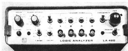
und sicheren Diagnose in Logikschaltungen bewährt. Es bietet Eigenschaften wie: 4 Kanäle, 256 bit Speicherung pro Kanal, kombinatorische Triggerung, kontinuierliche variable kalibrierte Einstellung der Schwellenspannung, Vor- und Nachtriggerung, leichtes Kaskadeschalten von mehreren Geräten.
