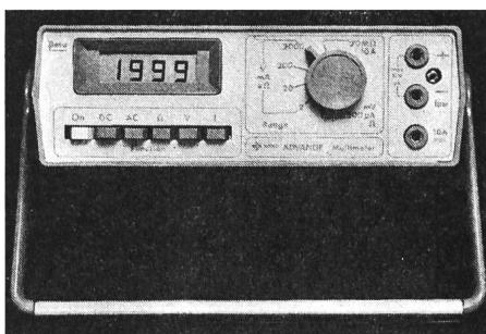
CMOS-Chip bestückt; digitale und analoge Schaltkreise sind mit dem Oszillatoren zusammen in einem Gehäuse untergebracht. Eine 10 mm hohe 3½-Digit-Flüssigkristallanzeige gewährleistet guten Kontrast bei extremen Lichtverhältnissen, lange Lebensdauer und minimalen Batterieverbrauch. 29 Messbereiche bieten die Möglichkeiten:
