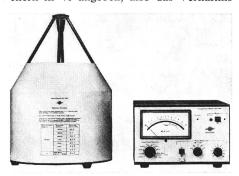
der akustischen Ausgangsleistung zur zugeführten elektrischen Leistung. Das Gerät ist eine kalibrierte Schall-Leistungsquelle, deren Ausgangsleistung stufenlos zwischen 40 und 100 dB bezogen auf 1 pW eingestellt werden kann. Das Ausgangssignal ist entweder breitbandiges Rosarauschen (100...10 000 Hz) oder Oktavbandrauschen mittels Einschleifen eines der 7 eingebauten Oktavbandfilter.
