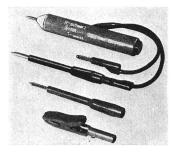
(weiss) angebracht ist. Zwei herausgeführte Kabel, schwarz für die Phase R und rot für die Phase S, tragen untrennbar verbundene 4-mm-Stecker. Ein schwarzer und ein roter Prüfstift mit abgeflachten Kontaktspitzen sowie eine isolierte Abgreifklemme werden mitgeliefert. Das Gerät funktioniert in 380-V- und 500-V-Netzen und entspricht HV 43440.8 und .9. Bei richtiger Phasenfolge erlöscht die Prüflampe beim Anlegen der letzten Phase. Bei falscher Folge leuchtet sie heller.
