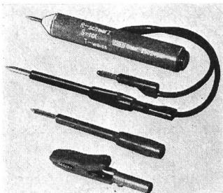
(weiss) angebracht ist. Zwei herausgeführte Kabel, schwarz für die Phase R und rot für die Phase S, tragen untrennbar verbundene 4-mm-Stecker. Ein schwarzer und ein roter Prüfstift mit abgeflachten Kontaktspitzen sowie eine isolierte Abgreifklemme werden mitgeliefert. Das Gerät funktioniert in 380-V- und 500-V-Netzen und entspricht HV 43440.8 und .9. Bei richtiger Phasenfolge erlöscht die Prüflampe beim Anlegen der letzten Phase. Bei falscher Folge leuchtet sie heller.
