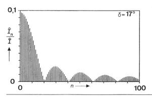
Fig. 5 Zwangskommutierter einpulsiger Stromrichter: Stromspektrum
