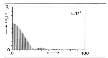
Fig. 7 Einpulsiger Stromrichter mit LC-Last: Stromspektrum
