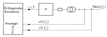
Fig. 12 Netzimpedanzmessung mit dem orthogonalen Korrelator:
