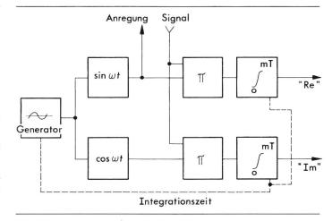
Fig. 10 Prinzip des orthogonalen Korrelators
