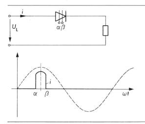
Fig. 4 Zwangskommutierter einpulsiger Stromrichter: Schaltung und Oszillogramme
