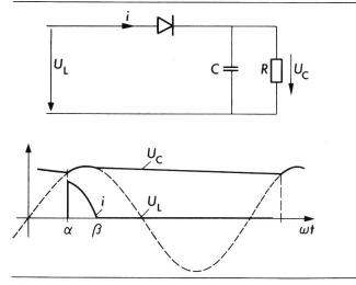
Fig. 2 Einpulsiger Gleichrichter mit RC-Last: Schaltung und Oszillogramme
