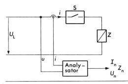
Fig. 1 Prinzip der Bestimmung der Netzimpedanz mit durch einen nichtlinearen Verbraucher erzeugtem nichtsinusförmigem Strom
