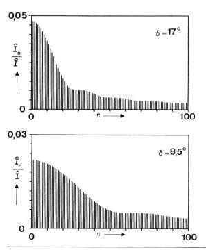
Fig. 3 Einpulsiger Gleichrichter mit RC-Last Spektrum des Netzstromes für zwei verschiedene Leitwinkel
