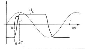
Fig. 6 Einpulsiger Stromrichter mit *LC*-Last: Schaltung und Oszillogramme
