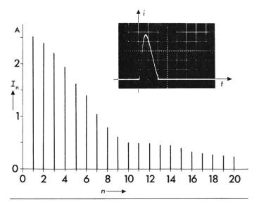
Fig. 8 Stromoszillogramm und gemessenes Spektrum für die Variante einpulsiger Stromrichter
