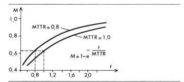
Fig. 2 Maintenabilité M en fonction du temps accordé pour une réparation, la MTTR étant paramètre
