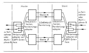
Fig. 7 Prinzip des Zweiebenenbetriebes im Multiplexer A
