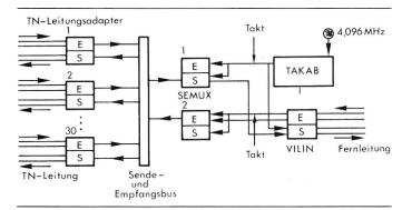
Fig. 5 Blockschema Multiplexer A
