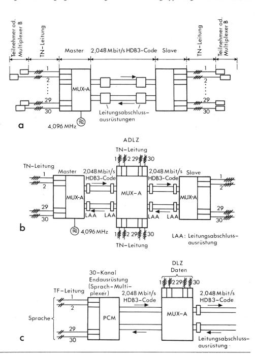
Einsatzmöglichkeiten des Multiplexers A a für Punkt-Punkt-Verbindungen
