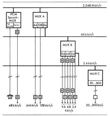
Fig. 3 Hierarchische Einstufung der Daten-Multiplexer im PCM-Netz der PTT
