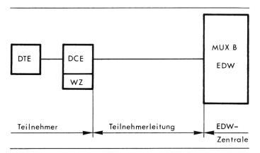
Fig. 9 Übertragung zwischen Datenendgerät und Multiplexer B
