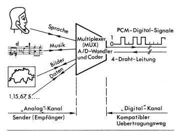
Fig. 2 Übertragung von Analog- und Digitalsignalen mittels PCM und Multiplexer
