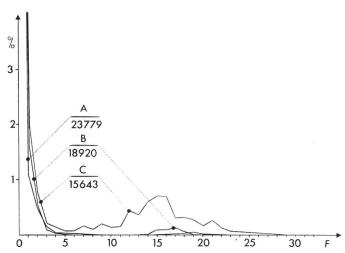
Fig. 9 Verteilung der Anzahl Fehler F pro Telegramm für die Übertragungsrichtung fix zu mobil in Prozenten aller ausgewerteten Telegramme
