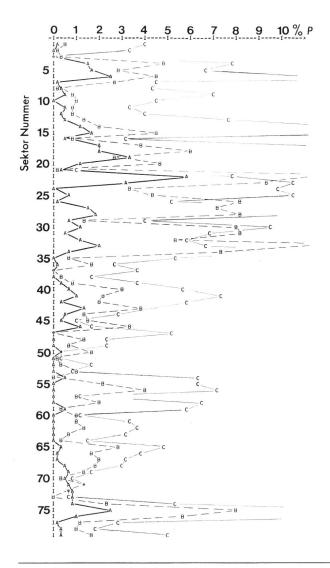
Fig. 6 Telegrammfehlerwahrscheinlichkeiten für die Übertragungsrichtung mobil zu fix
