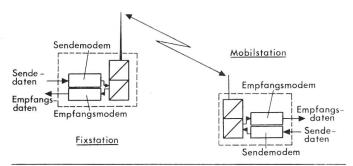
Fig. 1 Elemente einer Mobildatenfunkstrecke
