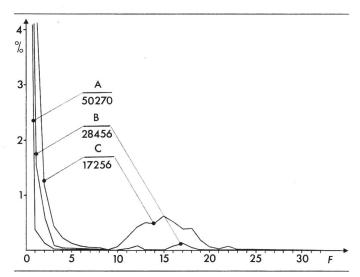
Fig. 8 Verteilung der Anzahl Fehler F pro Telegramm für die Übertragungsrichtung mobil zu fix in Prozenten aller ausgewerteten Telegramme
