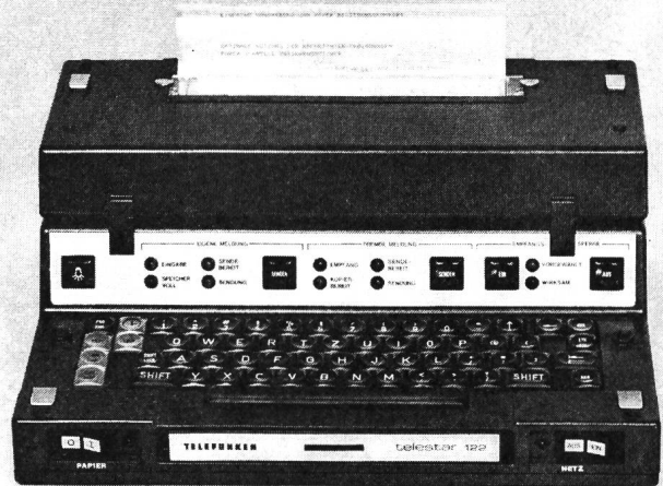
Korrespondenzgerät TELESTAR für den Datenaustausch zwischen mobilen und stationären Teilnehmern
