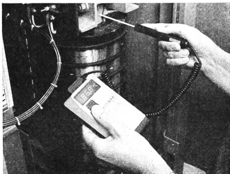
Messung der Oberflächentemperatur mit Technotherm Digital-Thermometer 1500
