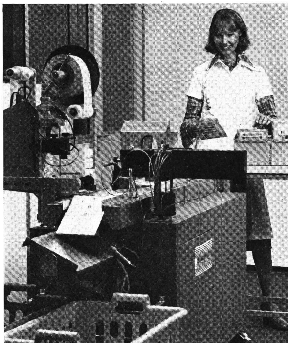
Automatische Datenerfassungsstation für Grossfotolabors
