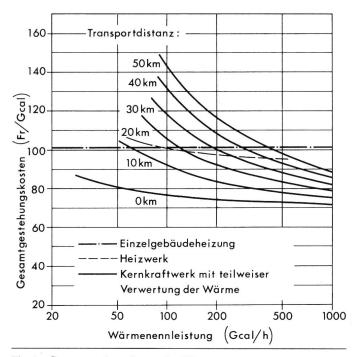
Fig. 2 Gesamtgestehungskosten der Wärme als Funktion der Wärmenennleistung
