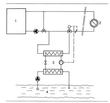
Fig. 4 Heizwerk mit Wärmepumpe
