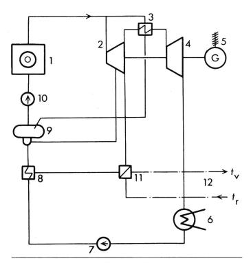
Fig. 1 Nukleare Anlage: Leichtwasserreaktor mit Entnahme-Kondensations-Sattdampfanlage
