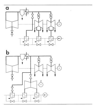
Fig. 8 Schaltungen von Turbinen von Leichtwasserreaktor-Heizkraftwerken
