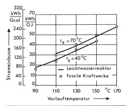
Fig. 7 Stromeinbusse bei Heisswasserlieferung aus Heizkraftwerken (2stufige Aufwärmung, Kondensatordruck 0,09 bar)
