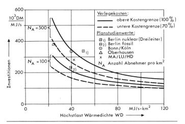
Fig. 4 Spezifische Investitionen der Unter- und Mittelverteilung
