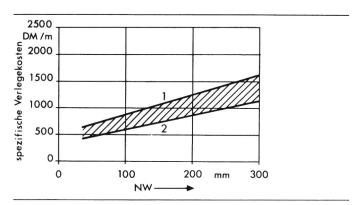
Fig. 2 Spezifische Verlegekosten für Heisswasserleitungen (Stand 1975)
