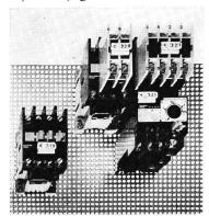
schaftlichen und zuverlässigen Schutz für Motoren gewährleisten die Thermorelais CT 3-12 und CT 3-16 mit Differentialauslösung. An jedem Relais wird eine präzise Grenzstromeichung vorgenommen. Die Relais sind mit den Funktionen Hand- und automatische Rückstellung versehen. Neu wurde die Funktion «STOP» eingeführt, die preisgünstige Starterkombinationen ermöglicht.
