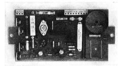
Kleinspannungsmotoren bis herab zu Nennspannungen von etwa 12 V-DC in einem überraschend grossen Regelbereich betrieben werden, ohne dass die Motoren mit Tachogeneratoren ausgerüstet sein müssten. Sogar einfache Katalogmotoren für Batteriebetrieb sind ausgezeichnet regelbar. Ein grosses Spektrum passender Regelmotoren, auch mit Permanentmagneterregung und mit Getrieben von 10 W bis 1 kW, kann auf Wunsch zu den Reglern geliefert werden.
