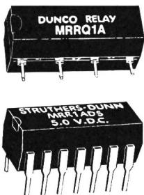
ten sie erstaunliche Möglichkeiten und eine preiswerte Alternative im Schaltungsbereich. Das umfangreiche DUNCO-MRR-Programm bietet Ausführungen mit bis zu 2 Umschaltkontakteien, mit Spulenennenspannungen von 5, 6, 12 und 24 V DC. Eine Ausführung mit 2 Spulen von 5 V oder 12 V (bistabil) ist ebenfalls erhältlich. Die direkte Ansteuerung durch DTL/TTL- und HTL-Logik ist möglich (*Roederstein Bauelemente-Vertrieb AG, 8201 Schaffhausen*)
