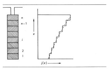
Fig. 2 Aufteilung des Nutenleiters in *n* Teilleiter j(z) Stromdichte als Funktion der Nutenhöhe i -ter Teilleiter des i-ten Teilkäfigs
