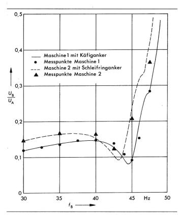
Fig. 6 Effektivwert der Zusatzspannung  $U_{\rm B}$  bezogen auf die Hauptspannung  $U_{\rm A}$
