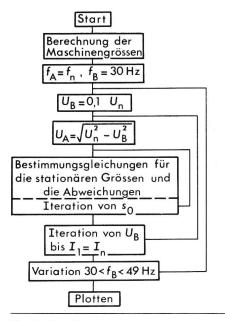
Fig. 5 Flussdiagramm der numerischen Berechnungen
