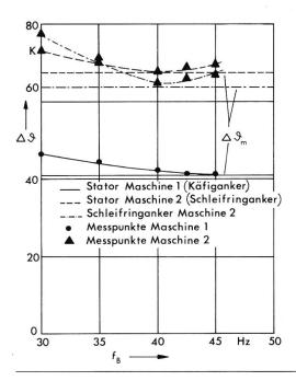
Fig. 12 Erwärmungsmessungen bei bifrequenter Speisung Δ9<sub>m</sub> Vergleichswerte der Wicklungserwärmung aus der Erwärmungsmessung durch mechanische Belastung an der Welle
