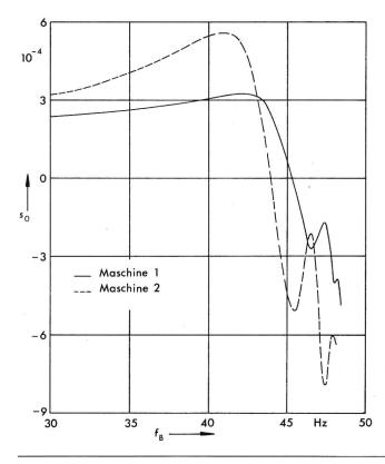
Fig. 8 Mittlerer stationärer Schlupf so des Rotors gegenüber dem Hauptsystem A
