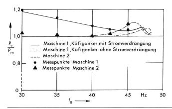
Fig. 11 Verlustleistung  $P_{\rm v}$  der Asynchronmaschine bezogen auf die Nennverluste  $P_{\rm vn}$
