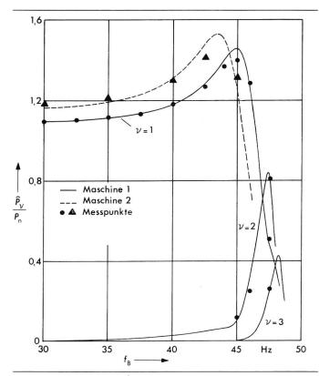
Fig. 10 Pendelleistungen  $\hat{P}_{V}$  der Asynchronmaschine bezogen auf die Nennleistung  $P_{n}$
