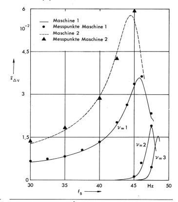
Fig. 9 Schlupfpendelungen  $\widehat{s}_{\Delta V}$  des Rotors gegenüber dem Hauptsystem A
