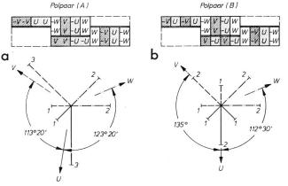
Fig. 13 Unterschiedlich gruppierte Polpaare (A) und (B) bei q=4/3 Nuten je Pol und Strang
