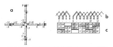
Fig. 11 Praktische Ausbildung der besser symmetrischen 6poligen Dreiphasenwicklung für N=12 Nuten
