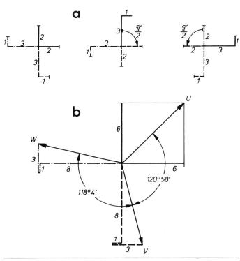
Fig. 10 Verbesserung der Phasensymmetrie für 2p = 6 und N = 12
