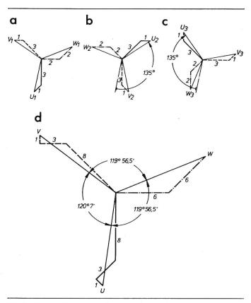
Fig. 5 Symmetrierung einer 6poligen Wicklung für N = 24 Nuten
