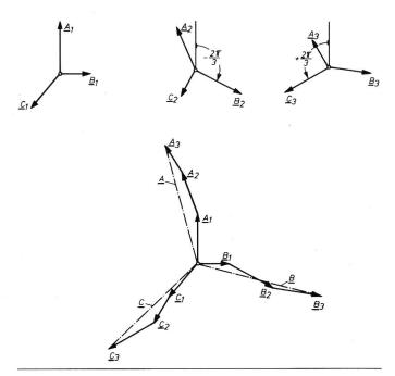
Fig. 1 Prinzip zur Symmetrierung eines unsymmetrischen Dreiphasensystems
