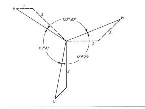
Fig. 4 Spannungssymmetrie der 6poligen Wicklung nach Fig. 3
