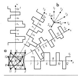
Fig. 12 6polige Dreiphasenwicklung für N = 12 Nuten
