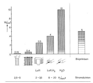
Fig. 3 Wärmestromdichten bei Aktivteilen elektrischer Maschinen
