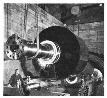
Fig. 5 Wassergekühlter Schenkelpolläufer eines Wasserkraftgenerators
