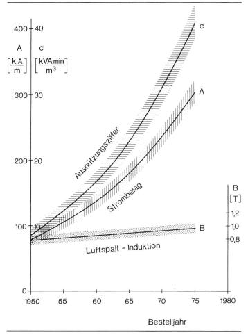
Fig. 2 Entwicklung der magnetischen und elektrischen Ausnützungen bei Turbogeneratoren
