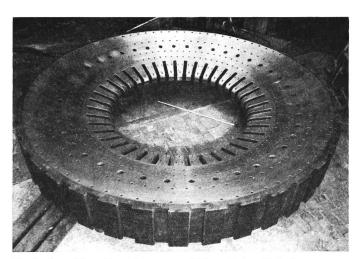
Lamellierte Pressplatte aus verklebten Elektroblech-Segmenten Fig. 8
