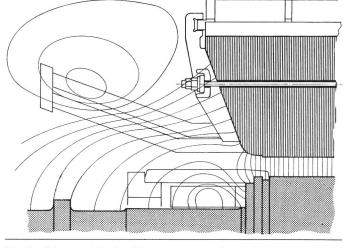
Stirnraumfeld eines Turbogenerators mit lamellierter Pressplatte
