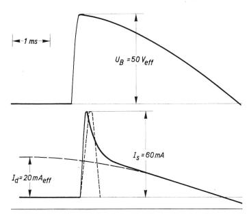
Fig. 2 Oszillogramm Kapazitiver Ausgleichsstrom
