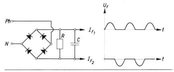
Fig. 6 Fehlerstrom I<sub>F</sub> bei Zweiweggleichrichtung mit ohmscher oder induktiver Last
