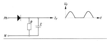
Fig. 5 Fehlerstrom  $I_{\rm F}$  bei Einweggleichrichtung mit ohmscher oder induktiver Last
