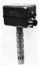
zwei Umschalter. Der Einstellbereich beträgt 0...95~0/o relative Feuchtigkeit, die Schaltdifferenz 3~0/o r.F., die Kontaktbelastung 5 (1) A bei 250 V $\sim$ .
