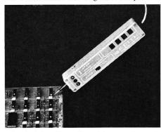
Die drei Logikpegelbereiche werden mit LED eindeutig angezeigt. Die Sonde ist für TTL- und CMOS-Schaltungen anwendbar.
