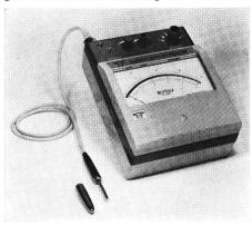
ten an Magneten und Magnetsystemen mittels Hallsonde als Messfühler. Das Gerät besitzt 6 Messbereiche zwischen 0,5 und 20 dT bei einer Genauigkeit von  $\pm 1\,^{0}/_{0}$  des Skalenbereiches, bezogen auf den eingebauten Eichmagneten von 3,5 dT. (Armin Zürcher, 8045 Zürich)
