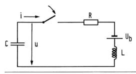
Fig. 3 RLC-Kreis mit Bogenspannung
