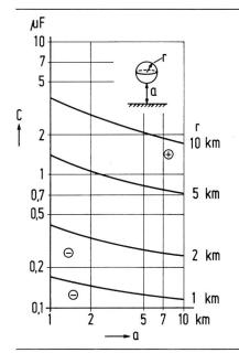
Fig. 4 Kapazitäten C kugelförmiger Wolkenspeicher in Abhängigkeit vom Höhenabstand a
