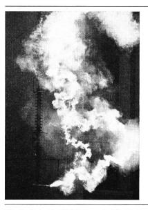
Fig. 3 Erdschlusslichtbogen mit 15 kA
