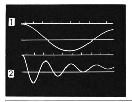
Spannungsoszillogramm einer schwingenden Schaltstossanlage
