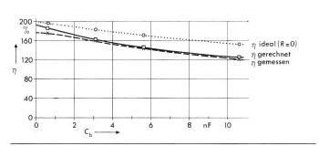
Fig. 5 Ausnutzungsgrad  $\eta$  in Abhängigkeit von der Belastungskapazität  $C_{\rm b}$   $C_{\rm S}=33~{\rm nF},~R=R_{\rm i}+R_{\rm a}=2,6~{\rm k}\Omega,~L=0,69~{\rm H}$
