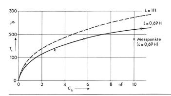
Fig. 4 Abhängigkeit der Stirnzeit  $T_{\rm S}$  von der Belastungskapazität  $C_{\rm b}$  Parameter: Induktivität L;  $C_{\rm S}=33~{\rm nF}$
