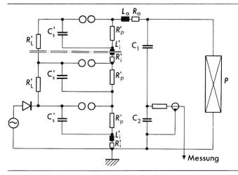
Fig. 3 n-stufiges Ersatzschaltbild für schwingenden Schaltstossgenerator
