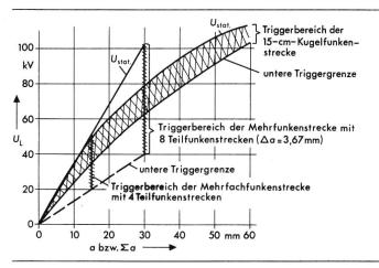
Fig. 10 Vergleich des Triggerbereiches einer Einfachfunkenstrecke (Ladespannung  $U_{\rm L}$ ) und der Mehrfachfunkenstrecke für einen 6stufigen Generator
