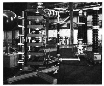
Fig. 6 Schwingende Schaltstossanlage
