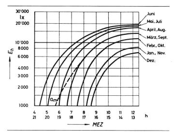
Fig. 2 Horizontal-Beleuchtungsstärke im Freien bei gleichmässig bedecktem Himmel in der Schweiz<sup>1</sup>)
