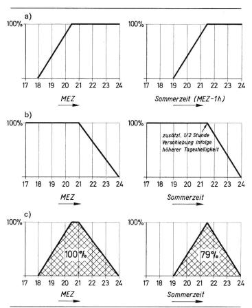
Fig. 1 Energie-Einsparungsmöglichkeiten bei der Haushalt-Beleuchtung
