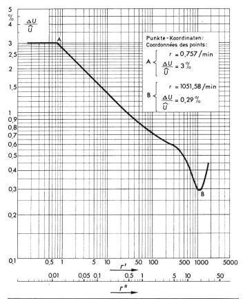
Fig. 1 Maximale Amplitude der relativen Spannungsänderungen in Funktion der Anzahl der Änderungen je Minute (Sekunde)
