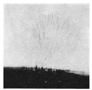
Fig. 10 Arborescences d'humidité dans un isolant
