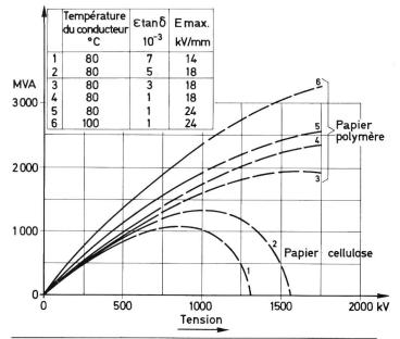
Fig. 6 Puissance de transport de câbles à huile de 1200 mm² (selon Fujita)
