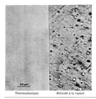
Fig. 9 Polyéthylène sans et avec des microvoids
