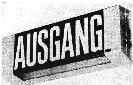
Brenndauer beträgt im Neuzustand ca. 1½-2 h. Das gefällige, stabile Gehäuse besteht aus naturfarbenem, matt anodisiertem Aluminium und bildet mit der fest eingebauten Abschirmung zusammen eine glatte Oberfläche, die schmutzabweisend und leicht zu reinigen ist. Die Abschirmung aus Acrylglass mit Pyramidenstruktur (nach innen gerichtet) bewirkt eine gleichmässige Lichtverteilung und hat eine Lichtdurchlässigkeit von 90 %.
