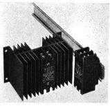
10 ms. Diese hohe Stoßstrombelastbarkeit erlaubt Anwendungen mit hohen Einschaltströmen. Spezifische Merkmale sind ferner die verschiedenen Arten der Ansteuerung: 3...30 V DC mit Schutz gegen Falschpolung oder 10...240 V AC, die galvanische Trennung von Eingangs- und Ausgangskreis durch Reedrelais oder Optokoppler mit Lastschaltung im Nulldurchgang sowie das Passen auf Normkühlkörper.
