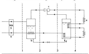
Fig. 6 Kühlung mit einphasigem Hochdruckgas
