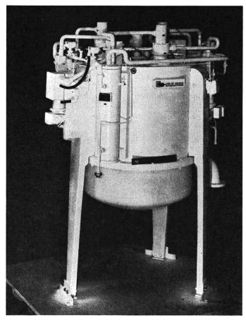
Fig. 9 Turbinen-Cold-Box der BNL-Anlage
