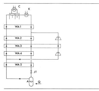
Fig. 1 Fliessbild einer einfachen Heliumkälteanlage
