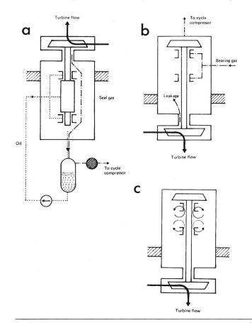
Fig. 3 Turbinen für Heliumkälteanlagen
