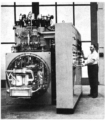
Cold Box mit Steuerschrank der SIN-Anlage
