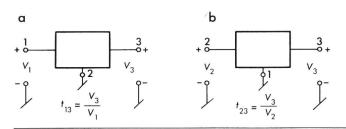
Fig. 24 Dreipol (a) und mit vertauschten Eingangs- und Masseklemmen (b)
