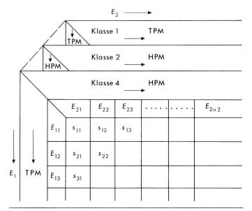
Fig. 26 Dreidimensionaler morphologischer Kasten für den Entwurf von VLF-aktiven Filtern
