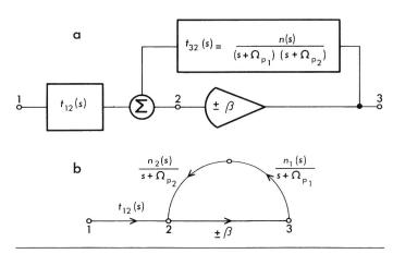
Fig. 18 Allgemeiner aktiver Filter 2. Ordnung a) Blockdiagramm, b) Signalflussdiagramm (SFD)
