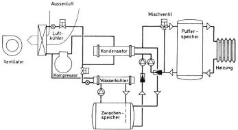
Prinzipschema der zweistufigen Aerocal-Wärmepumpe
